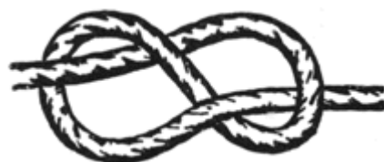
Nudo de ocho Para ajustar una cuerda a un agujero, para fabricar escaleras, se uza como corredizo o tope
